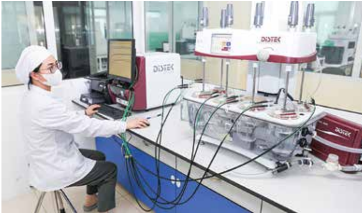
Máy đo quang UV sợi quang (In-situ UV fiber Optics) - nhà sản xuất Distek (Mỹ) cho kết quả tức thì, dùng để nghiên cứu độ hòa tan các sản phẩm mới so sánh với thuốc gốc
