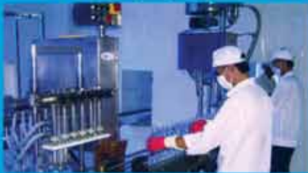
Hệ thống chiết rót chai tự động nước uống Bimico
